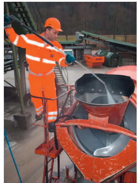
Das Wasser zur Reinigung der Transportfahrzeuge wird gefasst und wiederverwendet.
