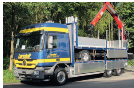
Das neue Landolt-Transportfahrzeug für Schrottautos, das bei Leerfahrten den Anhänger aufladen kann.
