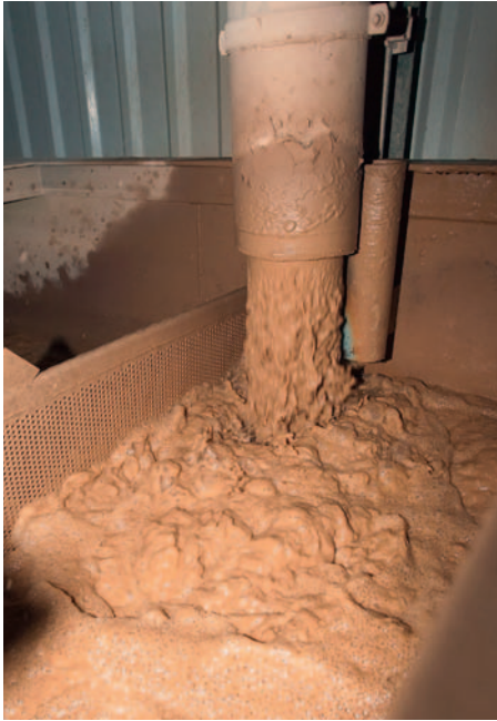
Schmutzwasser vom Kieswerk.
