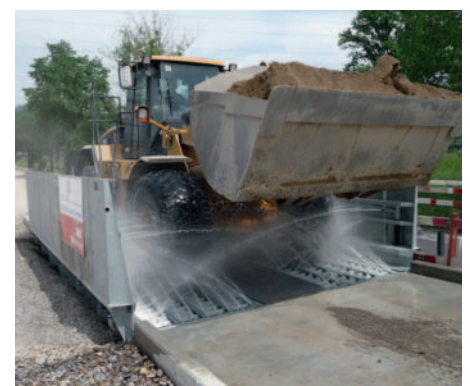
Das Wasser der Radreinigungsanlagen wird immer wieder neu genutzt.
