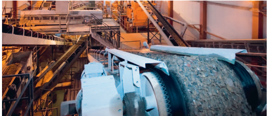
Blick ins Kieswerk, wo das vorgewaschene Material per Förderbänder transportiert wird.
